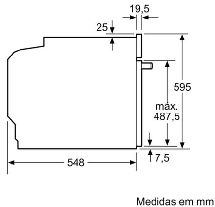
Instalação com uma placa de cozinhar.
