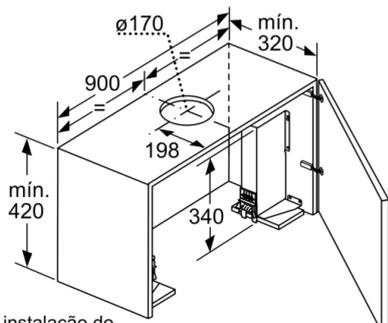
Na instalação do exaustor com painel plano de 90 cm num armário superior com 90 cm de largura é necessário um kit de instalação. Os dois suportes de instalação são aparafusados no móvel, à direita e à esquerda. Instalação de acordo com a matriz.
