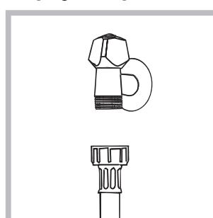
1. Pripojte prívodnú hadicu jej zaskrutkováním ku kohútiku so studenou vodou s hrndlom so závitom 3/4" (viď obrázok). Pred pripojením hadice nechajte vodu odtieciť, až kým nebudete číra.
