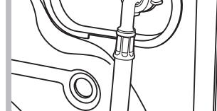
2. Ligue o tubo de alimentação na máquina de lavar roupa atarraxando-o no apropriado fornecimento da água, na parte traseira, em cima à direita (veja a figura).
