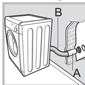
1. Deixe uma abertura na parede à esquerda do ponto no qual será instalada a máquina de secar roupa.
