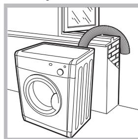
A extremidade do tubo deve ser virada para baixo, de modo a evitar que o ar quente húmido possa condensar-se no aposento ou na máquina de secar roupa.
