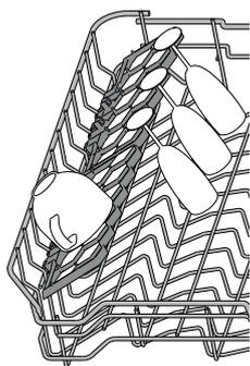
As abas laterais podem ser dobradas ou desdobradas para otimizar a disposição da loiça dentro do cesto.
