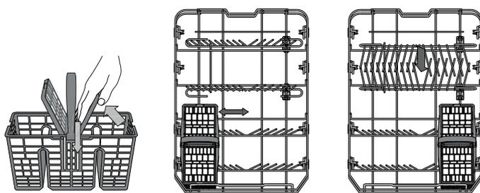
**As facas e os outros utensílios afiados têm de ser colocados no cesto dos talheres, com as extremidades voltadas para baixo ou horizontalmente nos compartimentos rebatíveis do cesto superior.**
