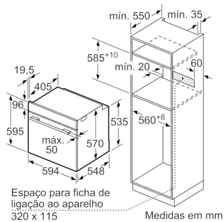
Instalação com uma placa de cozinhar.
