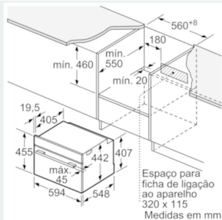
Instalação com uma placa de cozinhar.
