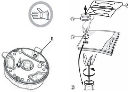
Antes de instalar a placa, não se esqueça de afixar a placa de calibração do gás fornecida com os injetores, de forma que esta cubra a informação anterior relativa à calibração de gás.
